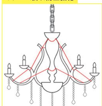
◆シャンデリアのアームが折れにくく、万一折れても落下しないように、極細ワイヤーでつなぎ、落下を防ぎます。
