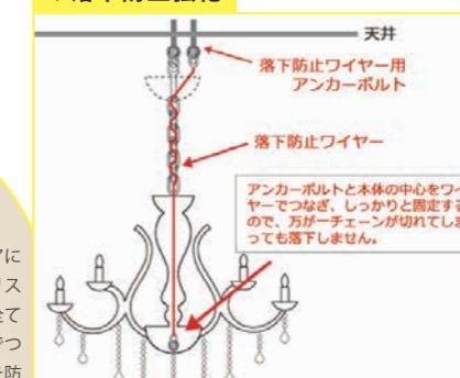
◆落防止ワイヤーを付け、天井取り付け箇所にはチェーン用アンカーと、落防止ワイヤー用アンカーの2本を設置します。
